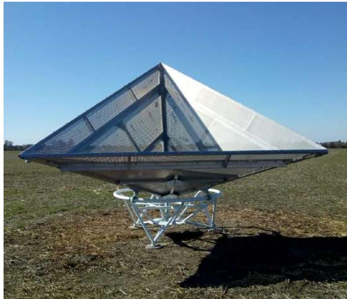
**Figura 2.8:** Reflectores tipo esquina o Corner Reflectors. Imagen obtenida por el EMIS en el campo experimental de la CONAE
