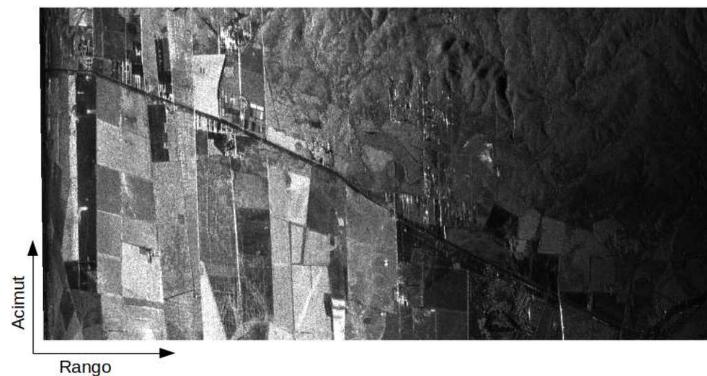
**Figura 4.5:** Imagen SLC-19 hh resultado del enfoque utilizando el algoritmo BP.
