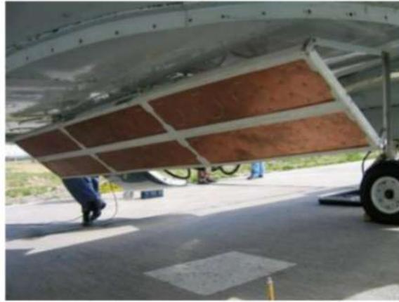
**Figura 3.2:** Antena del sistema SARAT [84].
