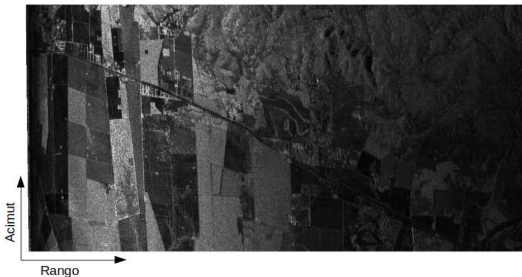
**Figura 4.4:** Imagen SLC-19 vh resultado del enfoque utilizando el algoritmo BP.
