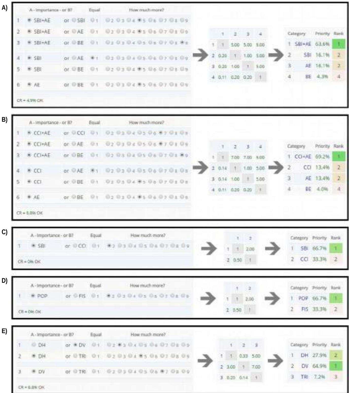
**Figura 1:** Comparaciones por pares de las variables, seguido por las matrices de los juicios y en el último paso, el valor de los pesos arrojados por el método AHP. Las imágenes corresponden a capturas de pantalla del programa disponible on-line a la página <http://bpmmsg.com>.
