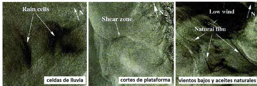
Figura 14 - Caracterización de distintos tipos de falsas alarmas, imágenes ERS (Espedal y Johannessen, 2000)
