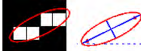
Figura 45 - Axis y orientacion de la elipse de referencia. El ángulo es definido por la horizontal y el axis mayor
