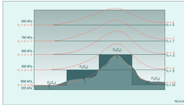
FIGURA 2.4: Representación esquemática de las coordenadas sigma y ETA.
