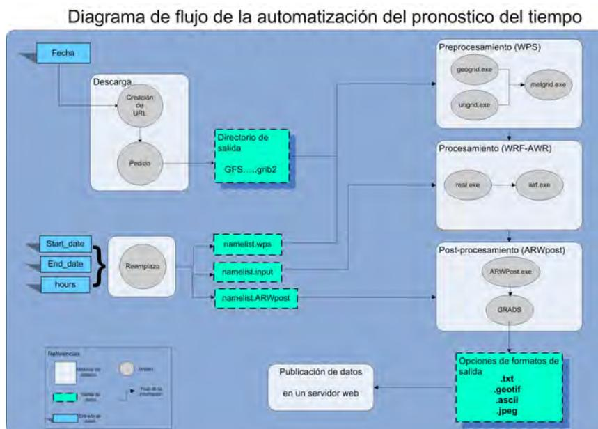
FIGURA 7.1: Diagrama de flujo completo de la automatización del pronóstico del tiempo.
