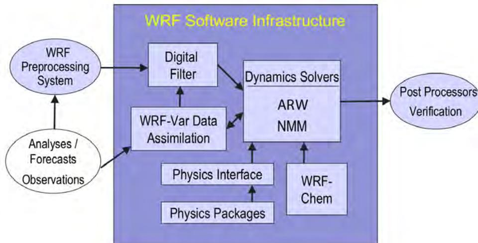
FIGURA 3.1: Componentes del sistema WRF.
