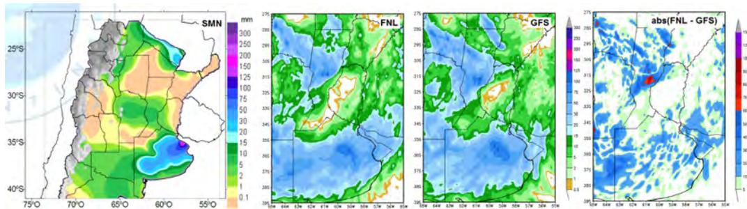
FIGURA 5.16: Precipitación acumulada diaria. De izquierda a derecha: SMN, WRF-FNL, GFS-WRF, Diferencia abs(FNL-GFS).
