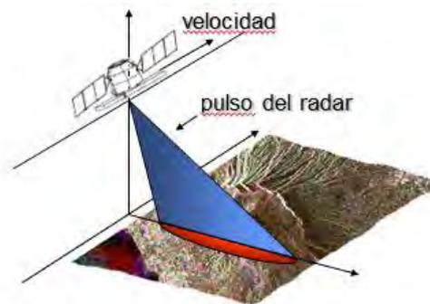
Figura 17: Radar, adquisición. Fuente: Lopinto (2010)
