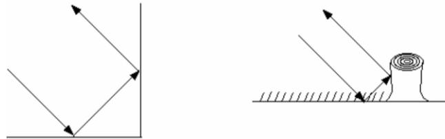
Figura 23: Mecanismos de dispersión: doble rebote. Fuente: SARMAP (2008)
