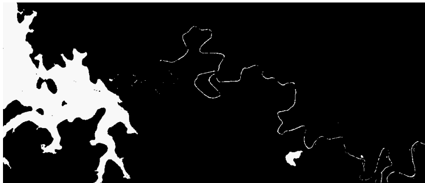
(b) Selección automática de muestras de clases AGUA y NO-AGUA en una banda de la imagen COSMO-SkyMed.
