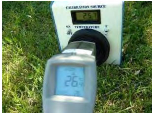
*Figura 3.2: Fuente de calibrado y sensor Raytex en etapa de intercalibrado.*
